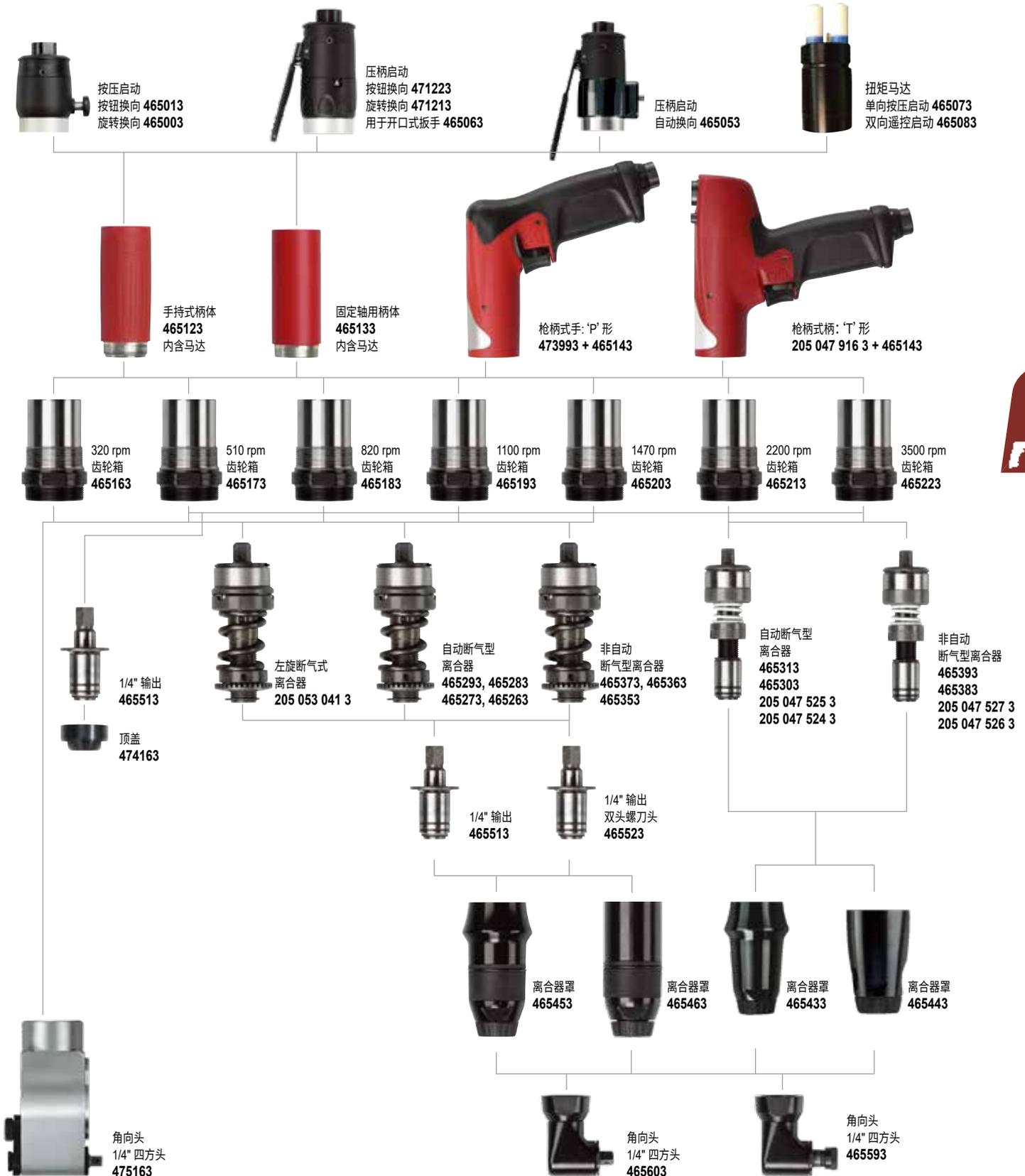
模块化结构, 是所有 Desoutter 气动螺刀一贯追求的设计理念
